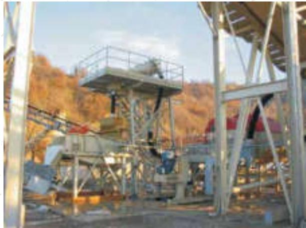
**Impianti di riciclaggio detriti provenienti dalla demolizione**
